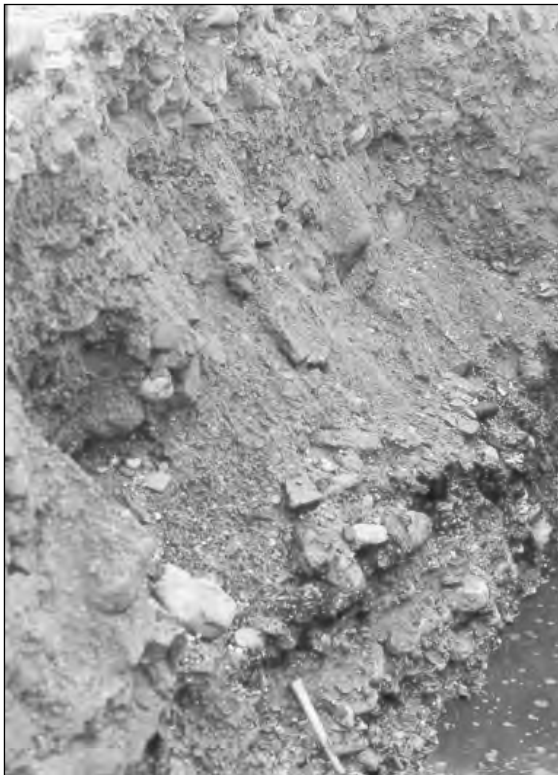
FIGURA 5. Rasa excavada al llit al·luvial del riu Tenes. Les sorres i graves de color marronós-groguenc s'han dipositat en davallar la crescuda (sediments remoguts). Les graves fosques (sediments intactes) mostren la profunditat màxima assolida per l'erosió durant la crescuda d'octubre de 1994.
