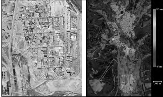
FIGURA 2. Mesures de subsidència mitjançant tècniques convencionals d'anivellació d'alta precisió (esquerra) i interferometria radar (dreta).
